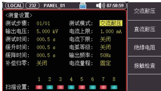
多种工作模式(交流耐压、直流耐压、绝缘电阻、接触检查)
